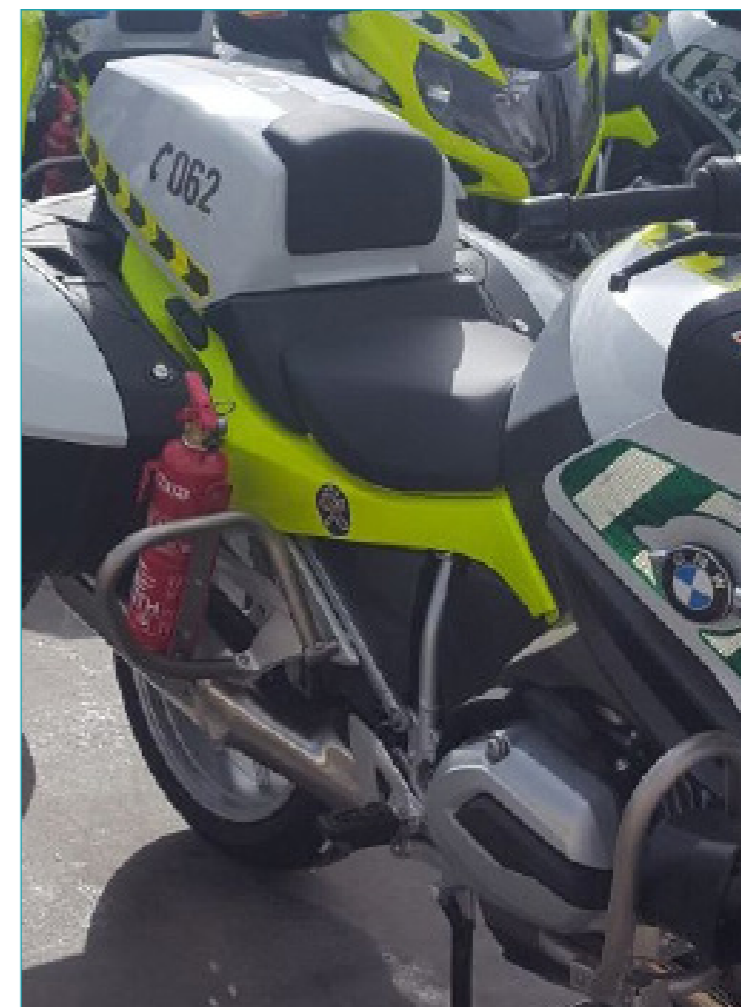
Extintor fijado irregularmente a una motocicleta oficial.
